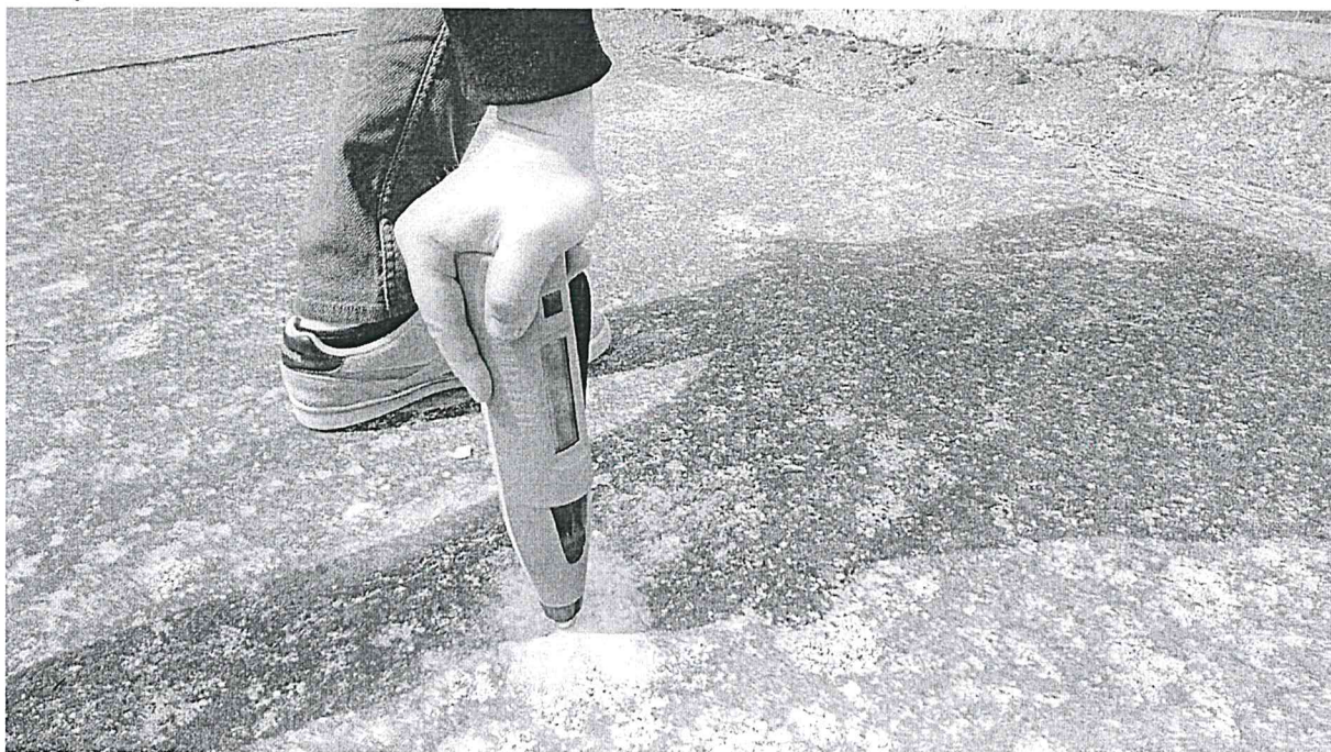
Fot.18. Badanie betonów płyty żelbetowej odwodnej zapory czołowej – metoda sklerometryczna.
