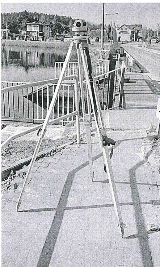
Fot.14. Pomiary geodezyjne zapory ziemnej czołowej.
